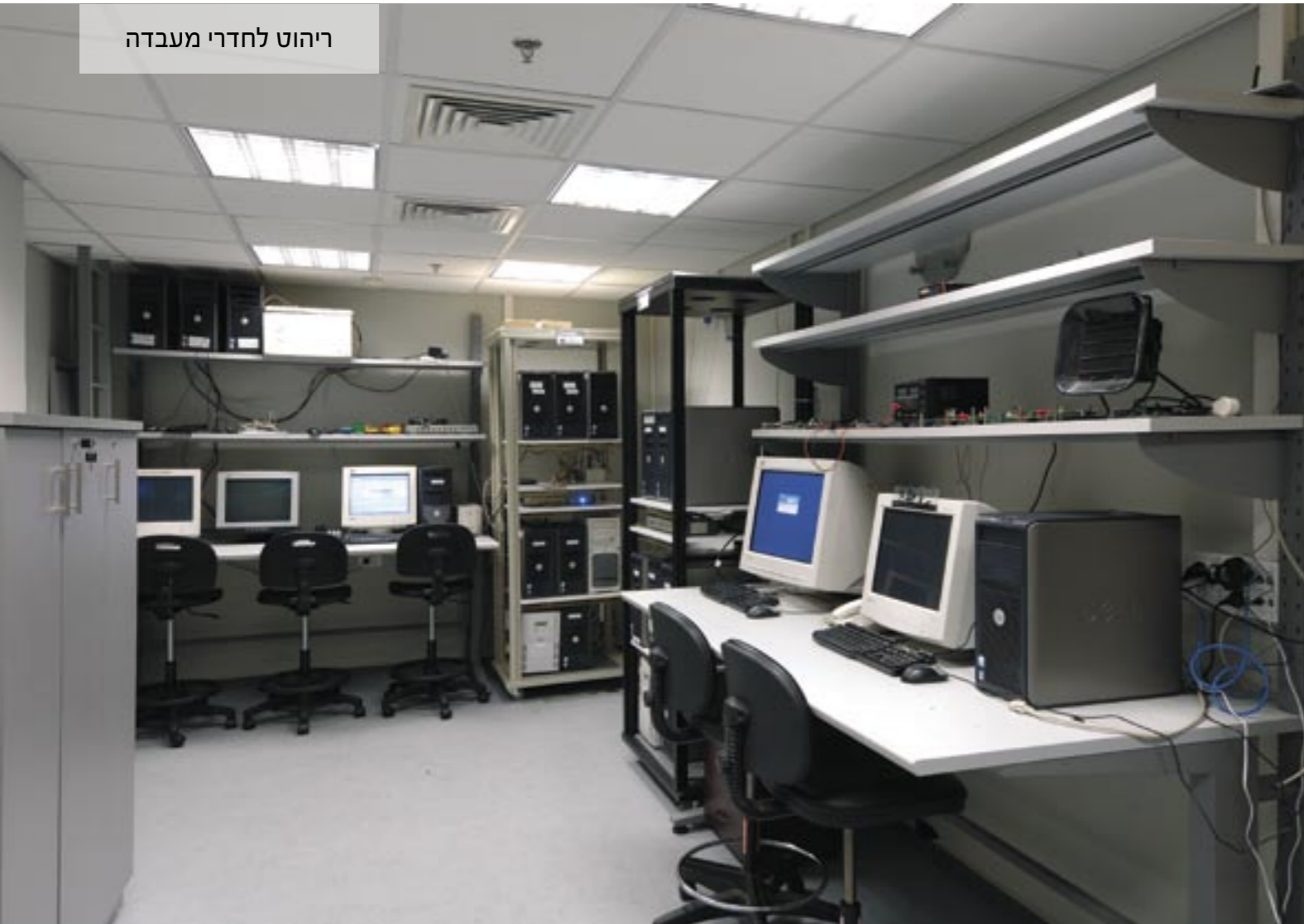
מבחר ריהוט ייחודי לחדרי מעבדה עם דגש על בטיחות ונוחות מרבית. משטחי עבודה מ.ד.פ. מחופה פורמייקה אנטי סטטי על רגלי C מודולריות בשילוב מדפים עליונים ותחתונים.
